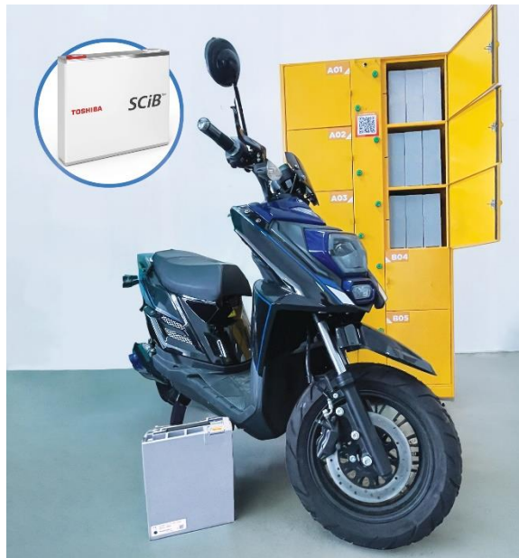
ภาพที่ 1 ชุดแบตเตอรี่ที่ใช้เซลล์ SCiB™ และตู้ล็อกเกอร์สำหรับชาร์จแบตเตอรี่ที่ใช้ในการทดสอบ พร้อมตัวรถมอเตอร์ไซด์
